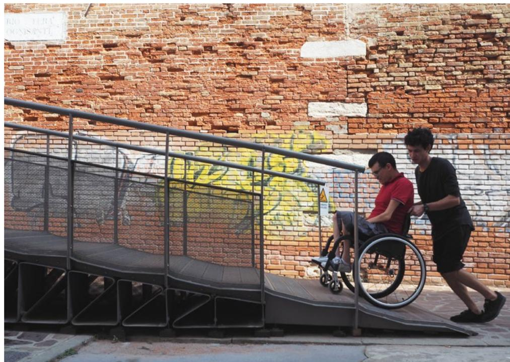
Fig. 1. Prove in situ per la valutazione della rampa a gradino agevolato sovrapposta al ponte Ognissanti. La ricerca luav ha analizzato il livello di comfort e sicurezza dell'utente in carrozzina con accompagnatore durante l'attraversamento di diversi tipi di rampa (foto di Rosaria Revellini 2017).
